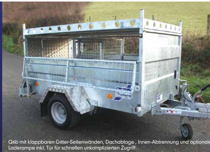
Q6b mit klappbaren Gitter-Seitenwänden, Dachablage , Innen-Abtrennung und optionaler Laderampe inkl. Tür für schnellen unkomplizierten Zugriff
