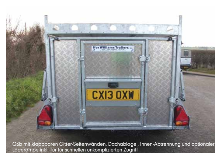
Q6b mit klappbaren Gitter-Seitenwänden, Dachablage , Innen-Abtrennung und optionaler Laderampe inkl. Tür für schnellen unkomplizierten Zugriff
