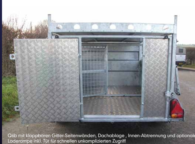
Q6b mit klappbaren Gitter-Seitenwänden, Dachablage , Innen-Abtrennung und optionaler Laderampe inkl. Tür für schnellen unkomplizierten Zugriff
